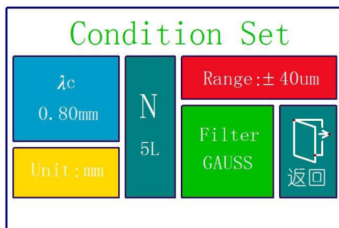
Imagen 133: Configuración de los parámetros de medición
