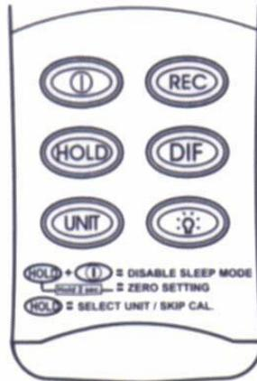
**REC** Accionando la tecla REC comenzará el modo de grabación de los valores MAX o MIN. Volviendo a accionar la tecla: lectura del valor MAX > lectura del valor MIN > indicador del tiempo de medición transcurrido en la parte inferior derecha de la pantalla. Aunque no se visualice, el tiempo de medición sigue transcurriendo mientras se indican los valores MAX o MIN. Manteniendo presionada la tecla REC durante 3 segundos se regresa al modo normal.
