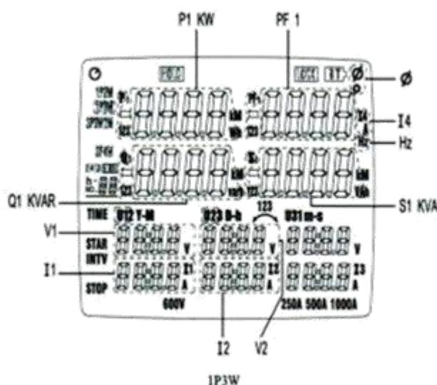
**Dikkat:** U2, U3, I1, I2, I3 gerilim ölçümünde U1 bağlanmış olması gerekmektedir. Çünkü U1 Ölçüm Cihazı için ana sinyal kaynağıdır. Yoksa ölçüm değeri elde etmezsinz.
