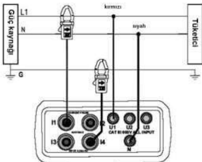
yan tarafında bulunan düğmeye basıp ağızını açınız ve açık ağızlı pensi „L1“ iletkenine bağlayınız. Topraklama iletken akımını ölçmek için „4“ ile tanımlanan pensin ağızını aynı şekilde açınız ve topraklamaya bağlayınız („G“ ile tanımlanmıştır).
