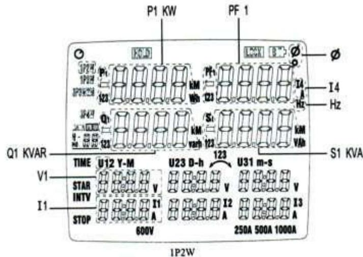
**Dikkat:** U2, U3, I1, I2, I3 gerilim ölçümünde U1 bağlanmış olması gerekmektedir. Çünkü U1 Ölçüm Cihazı için ana sinyal kaynağıdır. Yoksa ölçüm değeri elde etmezsinz.
