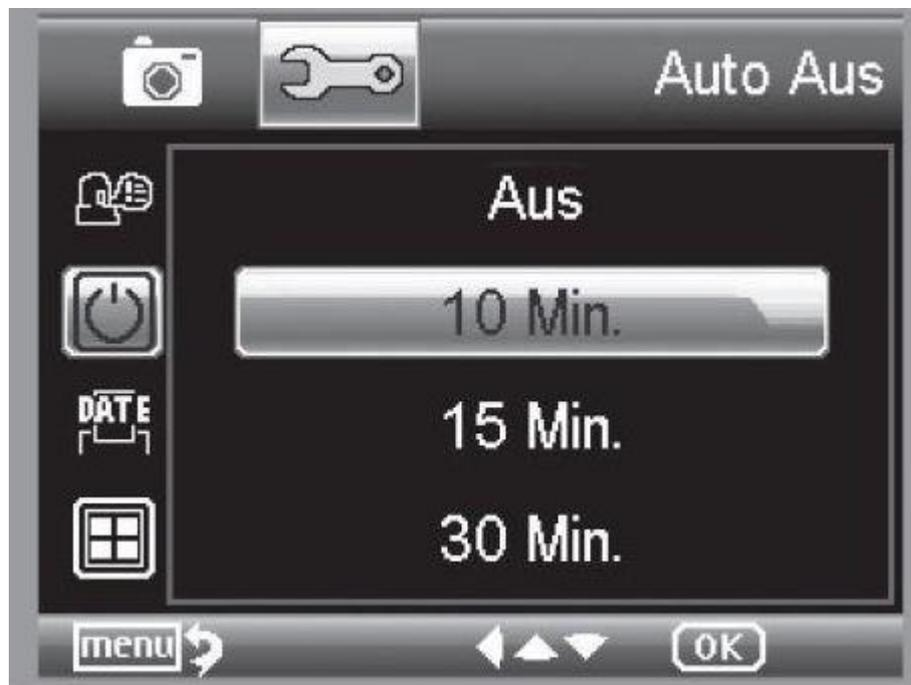
Cuando el modo de ahorro de energía „Apagado Auto“ está activado, el aparato se apagará transcurrido el tiempo ajustado previamente. Así se prolonga la duración de uso de la batería. Para desactivar el modo de ahorro de energía elija apagado.
