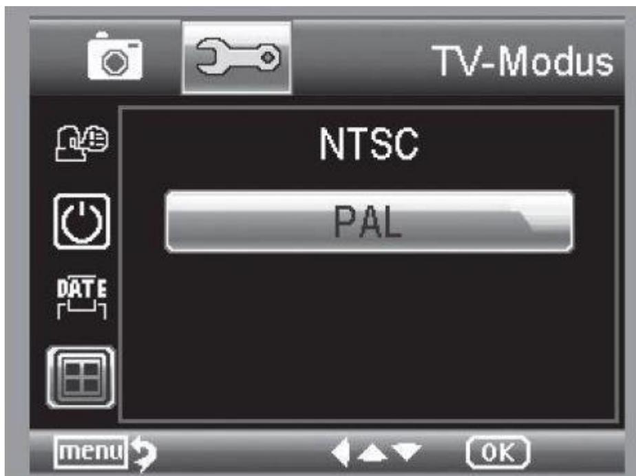
El aparato está equipado con una salida AV, en la que se puede conectar un televisor. Para Europa regule la norma de televisor en PAL. Al conectar el aparato al televisor mediante un cable AV, el PCE-DHM 10 se apagará automáticamente. Cuando se desconecte el cable AV, el monitor volverá a encenderse.
