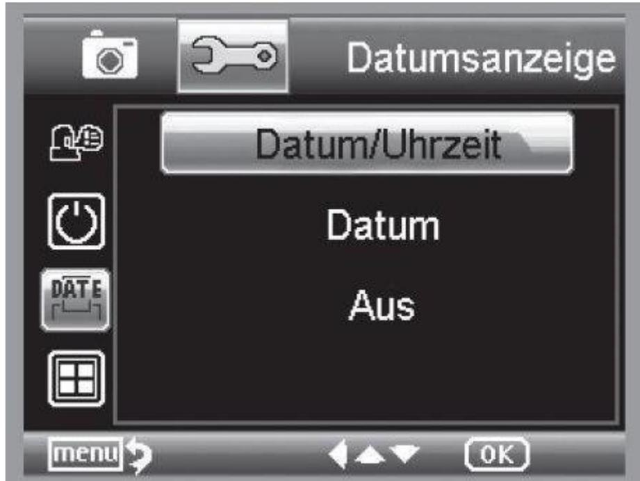
En este punto de ajuste se puede determinar si se visualizará fecha y hora, o solo fecha en la imagen. Si se ha seleccionado „apagado“ no se visualizará nada en la imagen. La visualización de fechas se efectuará en las capturas grabadas.
