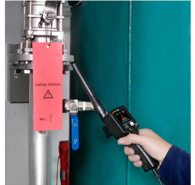
**Détecteur de fuites à ultrasons pour réseaux d'air comprimé / Facile à utiliser / Fréquence 40 kHz / Localisation au moyen d'écouteurs / Appareil résistant / Batterie**
