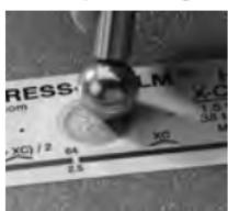
et 60 secondes pour comprimer entièrement toutes les parties du film sur toutes les surfaces. En général, il est préférable d'appliquer une compression plus importante que pas assez. Une fois le polissage (ou rodage) terminé, retirer le ruban de réplique de la surface.
