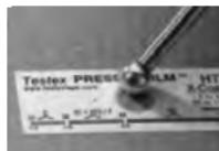
Drücken Sie den Replicafilm (Tape) fest mit dem abgerundeten Ende des beigefügten Glättwerkzeugs aus Edelstahl an, vorzugsweise im Kreisausschnitt. Wenden Sie ausreichend Druck in einer kreisförmigen und in x-y-Richtung durchgeführten Reibebewegung auf, um einen Abdruck mit einem gleichförmigen Kieselsteinaussehen herzustellen.
