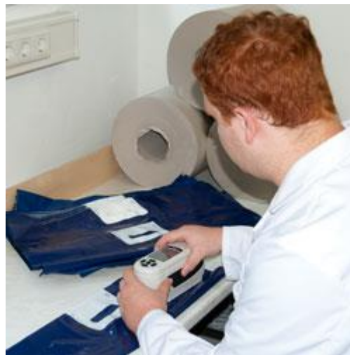
Bij glanzende producten kan met deze draagbare kleurmeter de kleur gecontroleerd worden. In dit voorbeeld bij folie.
