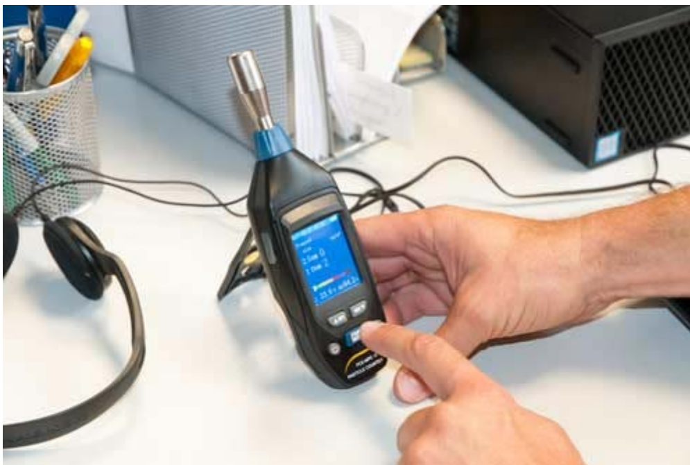
Hier ziet u de PM2,5 Fijnstofmeter PCE-MPC 10 bij een oriënterende meting op een kantoor.
