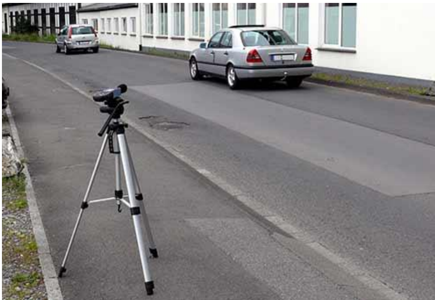
Geluidsmeter PCE-322A in gebruik bij een meting van verkeerslawaai, gemonteerd op statief (optioneel)
