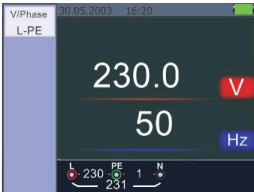
Afbeelding 5.2.7.2 Beeldscherm tijdens de meting van de spanning en de frequentie
