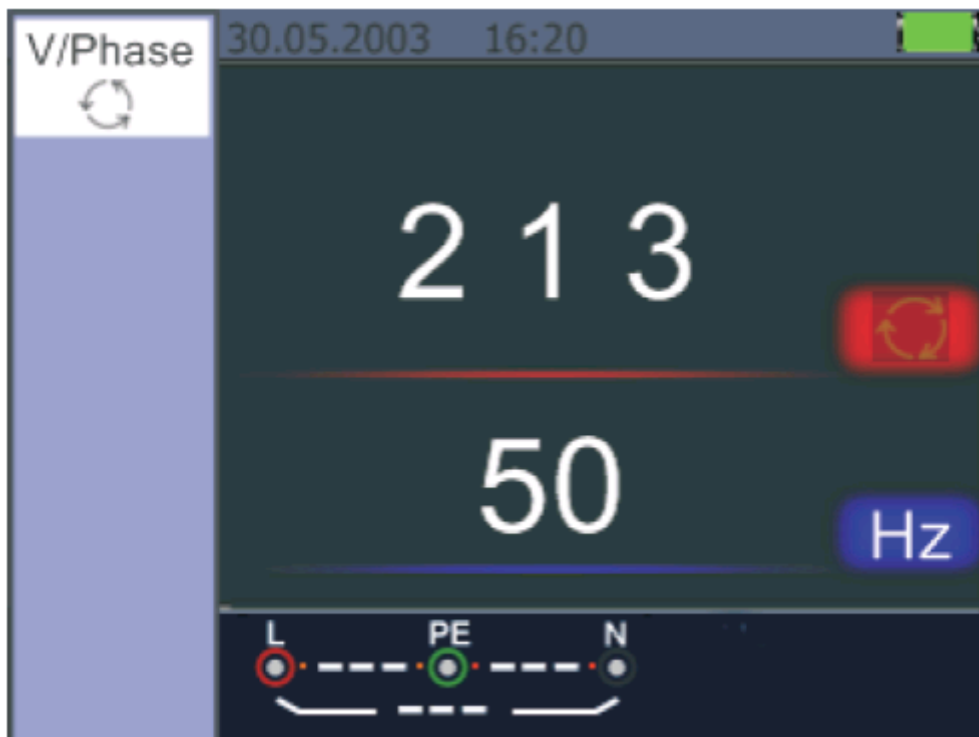
Afbeelding 5.2.8.3 Fasevolgorde beeldscherm wanneer in de foute volgorde 1,2,3 aangesloten
