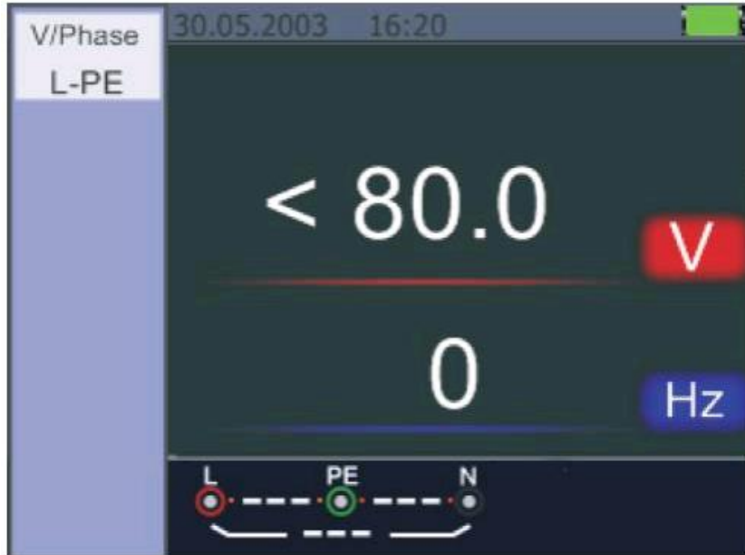
Afbeelding 5.2.7.1 Stand-by beeldscherm voor de spanning en de frequentie
