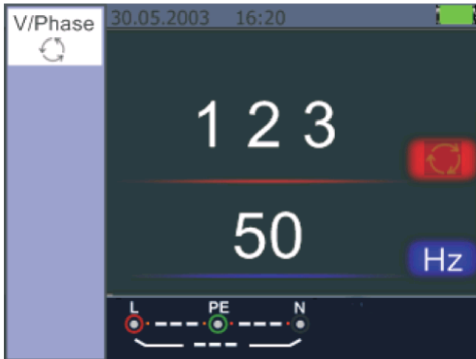
Afbeelding 5.2.8.3 Fasevolgorde beeldscherm wanneer in de juiste volgorde 1,2,3 aangesloten
