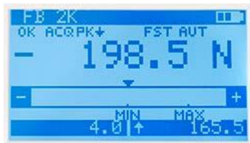
Draaimomentsleutel-tester: informatie zoals de batterijstatus, meetsnelheid, kracht, min- en max. gegevens in één oogopslag.
