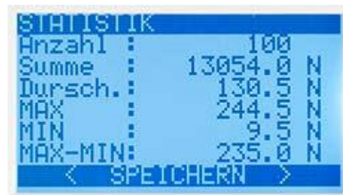
Statistiekfunctie in de draaimomentsleutel-tester met de mogelijkheid om gegevens intern op te slaan.
