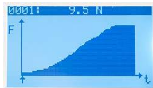
Draaimomentsleutel-tester: evaluatie of opslag van gegevens in een diagramvorm waarbij individuele meetpunten kunnen worden opgevraagd.
