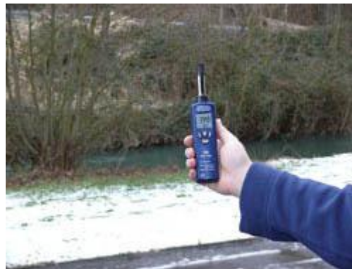
Voorkant van de manuele hygrometer PCE-555 bij het meten van vochtigheid binnenshuis.
