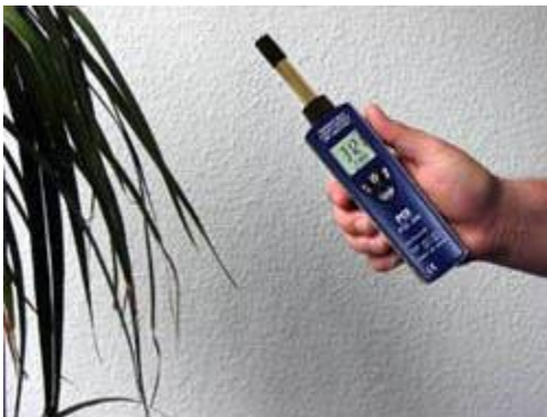
Manuele hygrometer PCE-555 bij het meten van kamervochtigheid.
