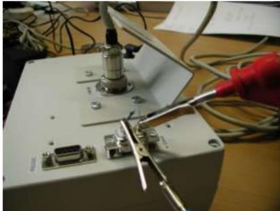
Test voorbeeld 4 20mA-interface met de weerstand R_{we} < 510\Omega .
