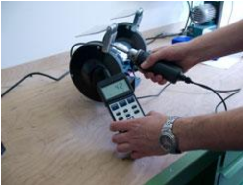
Draaimoment meter bij het meten van het koppelmoment bij een slijper
