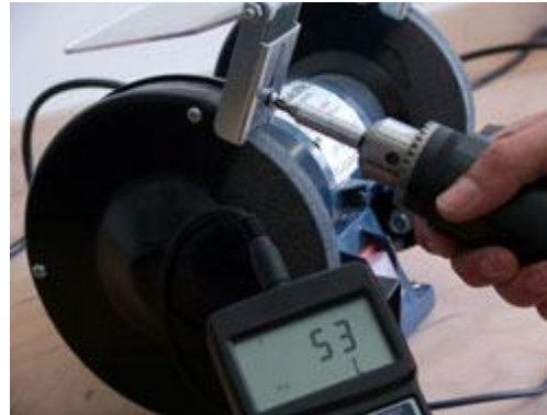
De gemeten waarden kunnen direct op het beeldscherm van de draaimoment meter afgelezen worden
