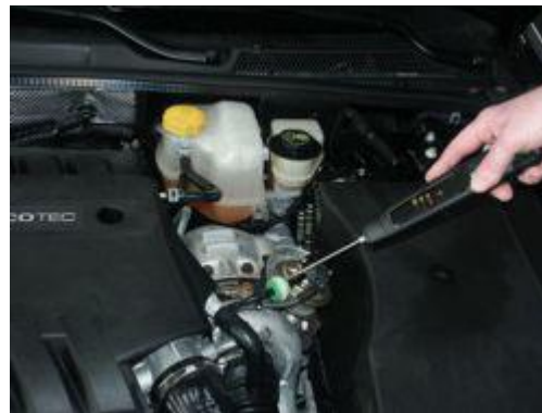
Gebruik van de elektronische stethoscoop PCE-S 41 bij het testen van een turbocompressor
