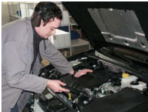
Gebruik van de elektronische stethoscoop PCE-S 41 bij het testen van een turbocompressor
