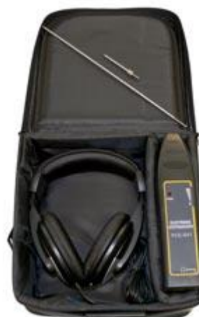
Gebruik van de elektronische stethoscoop PCE-S 41 bij het testen van een turbocompressor
