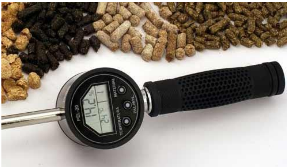
Vochtmeter voor pellets PCE-PEL 20 met verschillende soorten pellets
