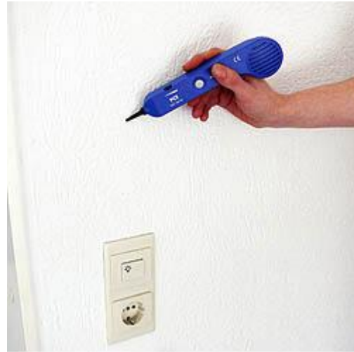
Tester tijdens het zoeken van een kabelonderbreking in een pleisterwerk
