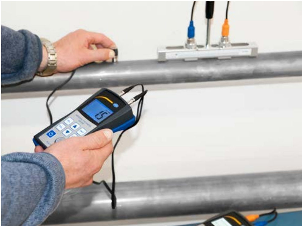
Hier ziet u de materiaaldiktemeter PCE-TG 50 bij een test van buizen
