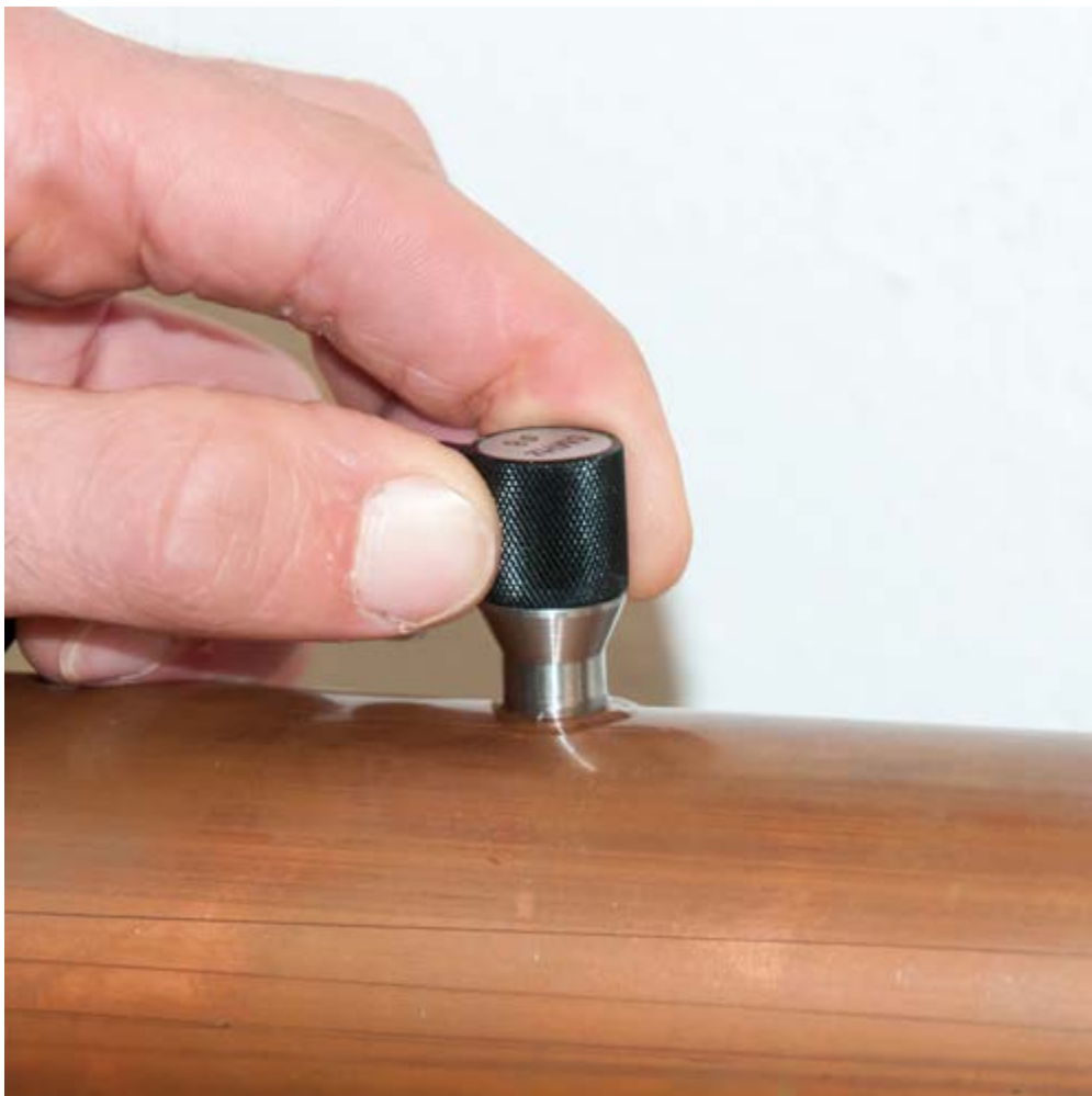
Hier ziet u de materiaaldiktemeter PCE-TG 50 bij een test van buizen
