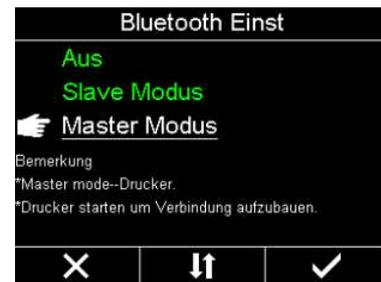
Das Messgerät versucht, eine Verbindung mit dem Drucker über Bluetooth herzustellen. Warten Sie einige Sekunden. Wenn die Bluetooth Status LED dauerhaft leuchtet, ist die Verbindung zwischen dem Messgerät und dem Drucker hergestellt.
