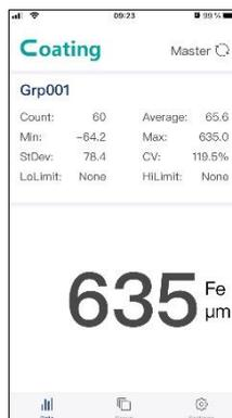
Unter dem Reiter „Group“ werden Ihnen die auf dem Messgerät gespeicherten Messdaten angezeigt. Unter der Funktion „Export“ können Sie die Daten auf dem mobilen Endgerät als CSV, PDF und auch als TXT Datei abspeichern.
