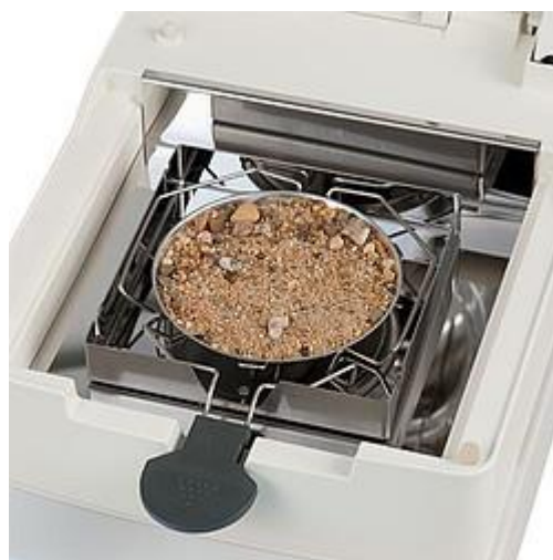
Het te meten medium wordt gedroogd op een sampleschaal in de vochtanalyser.
