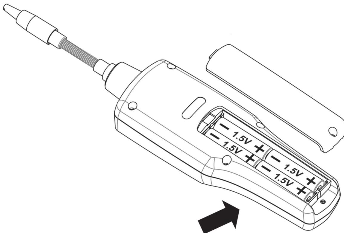
Um eine Spannungsversorgung über Batterien durchzuführen, öffnen Sie das Batteriefach auf der Rückseite. Legen Sie anschließend vier 1,5 V AA Batterien ein. Achten Sie beim Einlegen auf die Polung. Verschließen Sie nach dem Einlegen der Batterien das Batteriefach.
