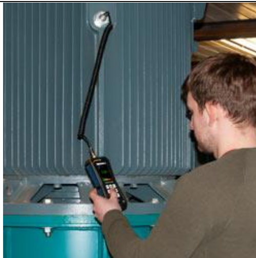
Metingen van de trilling van een generator met de trillingsmeter
