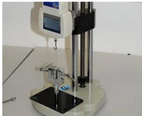
Kracht testbank: De trekproef wordt gespannen.
