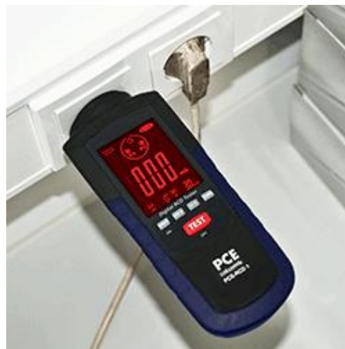
De kleur van het scherm verandert naar rood wanneer de grenswaarden worden overschreden of de aarding niet wordt gedetecteerd.
