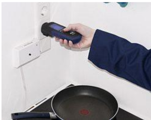
De FI / RCD tester PCE-RCD 1 tijdens het testen van het systeem in een huis. Het grote scherm maakt het bedienen makkelijker.
