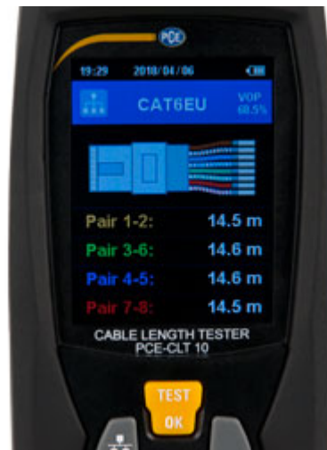
Display van de kabellengtemeter PCE-CLT 10
