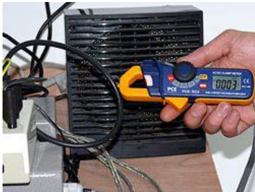
Ampèremeter PCE-DC 3 bij het bepalen van de spanning van een elektrische kabel.
