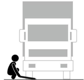
**mobile Fahrzeugwaage / max. Radlast der Fahrzeugwaage 1500 kg / Radlastberechnung, Achslastberechnung, Gesamtgewichtberechnung, Summierfunktion / Display mit Drucker**
