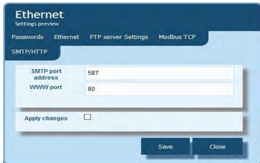
Bild 20. Ansicht des Fensters zur Konfiguration des SMTP-Ports auf der Schaltfläche "Ethernet"
