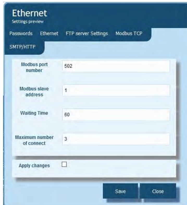
Bild 21. Ansicht des Fensters zur Konfiguration der Parameter Modbus TCP auf der Schaltfläche "Ethernet".
