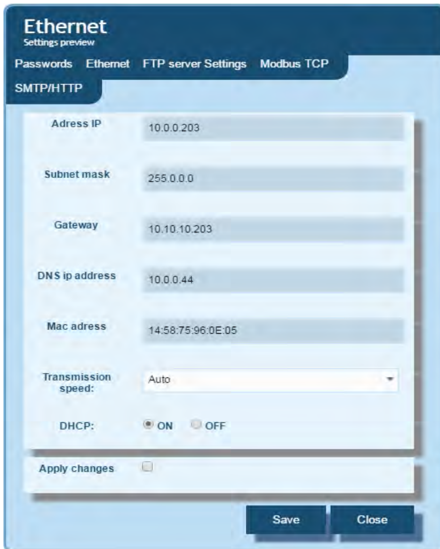
Bild 7. Ansicht des Fensters der Änderung der Parameter der Ethernet-Schnittstelle
