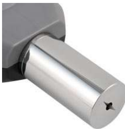
Messspitze des Thermoplast-Härteprüfer PCE-DDD 10
