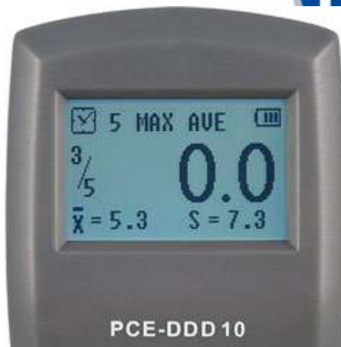
Display des Thermoplast-Härteprüfer PCE-DDD 10
