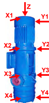
Bild 12: Messorte an Maschinen mit vertikalem Rotor
