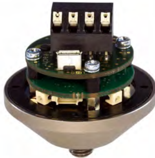
Bild 1: Anschlussklemmen und USB-Buchse im PCE-VS11
