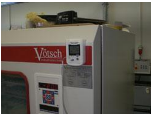
Klimaprüfung in Brutschränken (mit externem Sensor)
