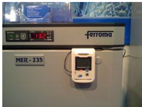
Kühlschranküberwachung ebenfalls mit externem Temperatursensor
