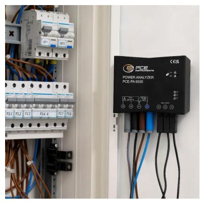
Speicher ermöglicht eine sekündliche Datenaufzeichnung über einen Zeitraum von mehr als einem Jahr. Für den Betrieb ist keine zusätzliche Stromversorgung erforderlich, da die Messung über Magnetmessspitzen oder Anschlussklemmen erfolgt. Mit einer kompakten Bauform von 123 x 96 x 36 mm und einem Gewicht von lediglich 202 g ist das Gerät leicht zu handhaben. Zudem erfüllt es die Schutzklasse IP40, was es für verschiedene Einsatzbereiche ideal macht.
