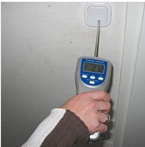
Kraftmessgerät bei der Ermittlung der benötigten Schalterkraft
