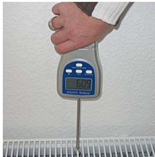
Kraftmessgerät bei der Ermittlung der Gewichtskraft
