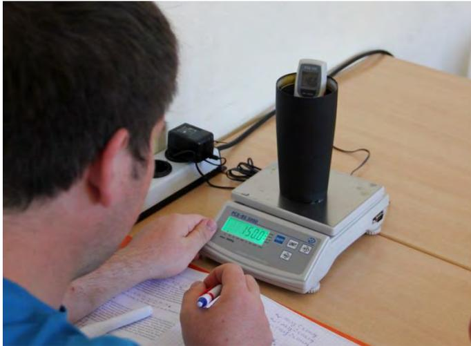
Abb.2 – Bestimmung der Kalorimeterkonstanten eines Thermobechers
