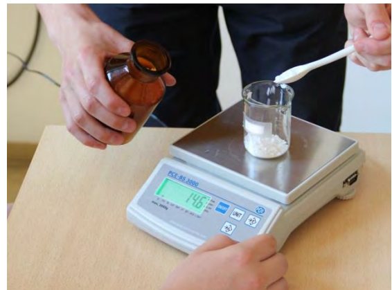
Abb. 4 – Ein Schüler beim Wiegen von \text{CaCl}_2 , dessen Lösungswärme bestimmt werden soll
