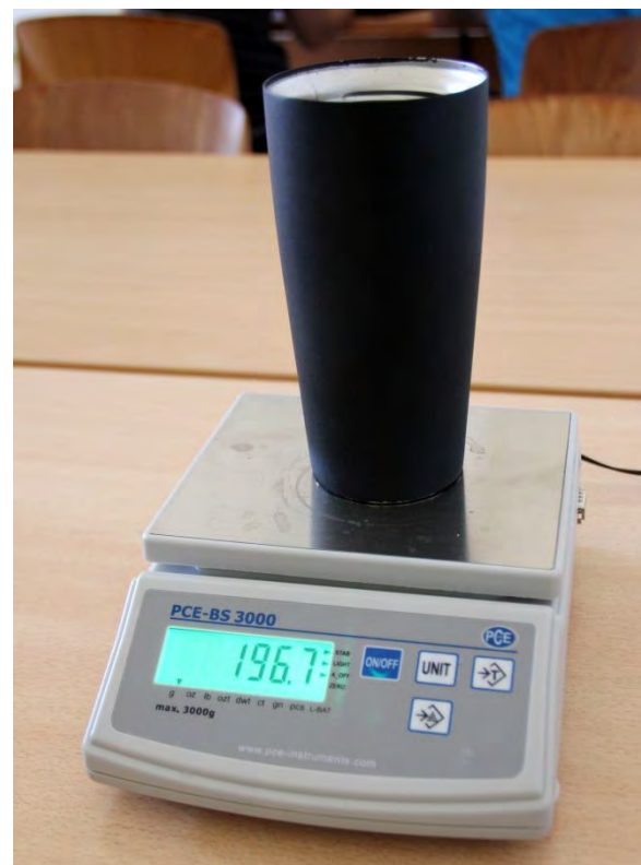
Abb.1 – Bestimmung der Schmelzwärme von Eis mit Hilfe der Analysenwaage PCE-BS 3000
