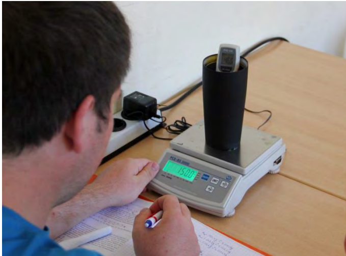
Abb.2 – Bestimmung der Kalorimeterkonstanten eines Thermobechers
