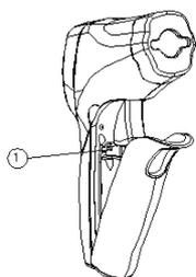
Wählen Sie die gewünschte Temperatureinheit (°C oder °F) anhand des °C/°F-Schalters ①, der sich, wie im Bild gezeigt, im Inneren des Thermometers befindet.
