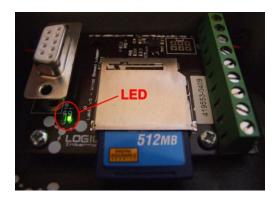
**LED AUS:** Der Logger befindet sich im normalen Speichermodus. Die LED blinkt im eingestellten Aufnahmeintervall. Ist das Intervall auf 10s eingestellt, so blinkt die LED alle 10s. Wenn das Aufnahmeintervall beispielsweise auf 1min eingestellt ist, so wird die LED im 1min Abstand aufblinken.
