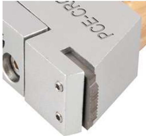
Das Gitterschnittprüfgerät PCE-CRC 10 mit wechselbaren Schneidmessern.
