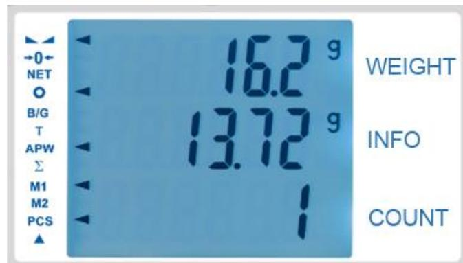
Das Display der Zählwaage ist in vier Bereiche aufgeteilt. „WEIGHT“ / „INFO“ / „COUNT“ und den linken Statusbereich „◀“. „WEIGHT“ Zeigt Ihnen das aktuelle Gewicht an welches sich auf der Waage befindet. „INFO“ ist ein Bereich der je nach Funktion die gewünschten Informationen zeigt wie z.B. Stückgewicht oder Summe usw. Der „COUNT“ Bereich zeigt die Stückzahl an.
