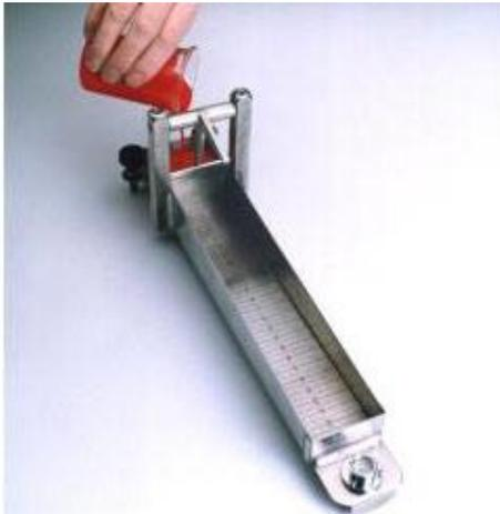
Einfüllen des Messmediums in das Bostwick-Consistometer ZXCON
