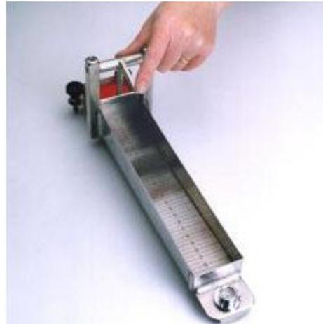
Öffnen des Schiebers an dem Bostwick-Consistometer ZXCON
