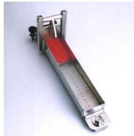
Ablesung der Fließlänge im Bostwick-Consistometer ZXCON
