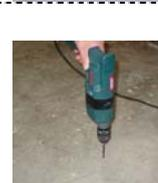
☞ Mit dem beiliegenden Betonbohrer in einem Abstand von etwa 25 cm zwei Löcher in das zu untersuchende Material bohren.
