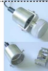
☞ Die Becherelektrode mit dem zu untersuchenden Material füllen und die Becherelektrode schließen.
