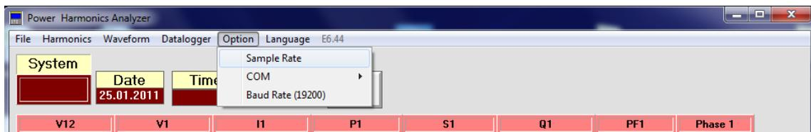
Um die Speicherrate einzustellen wählen Sie im Menü „Option“ den Eintrag „Sample Rate“. Im sich öffnenden Dialog geben Sie die gewünschte Speicherrate in Sekunden ein (die kleinste Speicherrate beträgt 2 Sekunden) und bestätigen mit „OK“.
