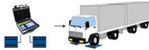
Achslast - Wägung mit der Fahrzeugwaage
