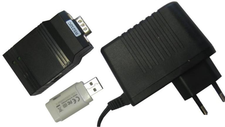
Der Logger ermöglicht die Sendedaten der RS-232 Schnittstelle als TXT Format in einen oder mehreren Ordnern mit Zeit und Datum zu speichern. Der Logger kann sowohl Daten empfangen als auch abfragen. Mit der entsprechenden Konfiguration (Pinbelegung der RS-232 Schnittstelle beachten) kann also der PCE-USM Adapter mit jeder RS-232 Schnittstelle verbunden werden um die Daten aufzuzeichnen.
