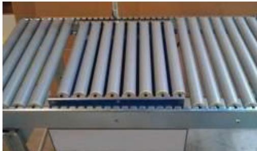
Frontansicht der Rollbahnwaage
