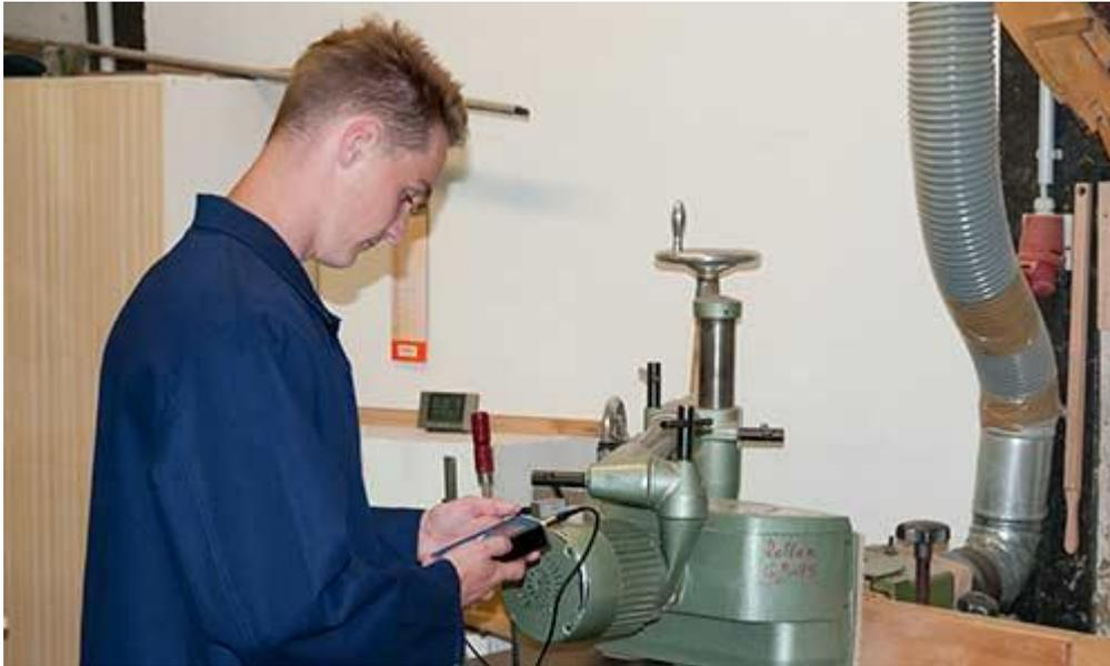
Das Vibrationsmessgerät PCE-VM 3D während einer Messung an einem Motor.
