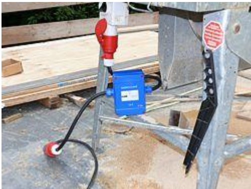
Hier sehen Sie den mobilen Drehstromzähler Easycount auf einer Baustelle vor der Kreissäge
